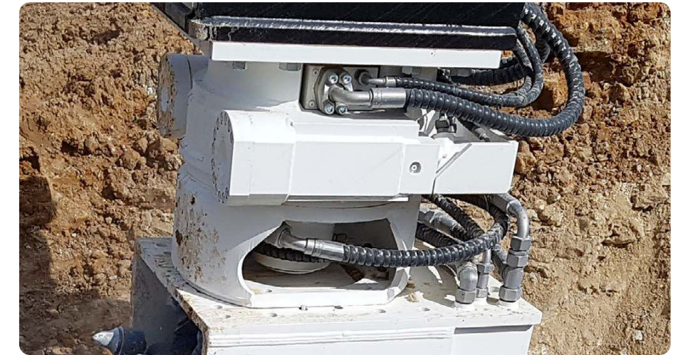
▲ Une unité de rotation KRM 70 étend les capacités d'une fraise.
