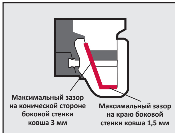
4. Потяните за шаблон так, чтобы штифты плотно прилегали к переднему краю монтажных отверстий, и убедитесь в том, что шаблон контактирует с внешней поверхностью боковой стенки. Зафиксируйте шаблон, используя 2 винта на его передней стороне. С помощью калиберных щупов проверьте зазоры в указанных зонах, как показано на рисунке. Максимальный допустимый зазор на переднем краю боковой стенки составляет 1,5 мм, а на внутренней конической стороне — 3 мм. Повторите эту операцию в отношении остальных мест установки верхних боковых защитных сегментов.
